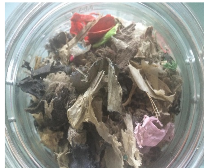
Combustible Solide de Récupération
