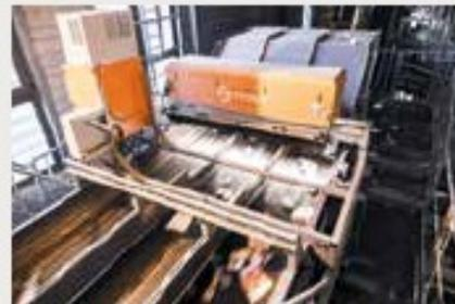
**3** Séparation automatique des différents types de déchets (tri magnétique, granulométrique, balistique et optique).
